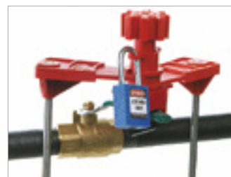
ブロッキングアーム2個使用でオン、オフ、スロットルの各位置に固定できる。
